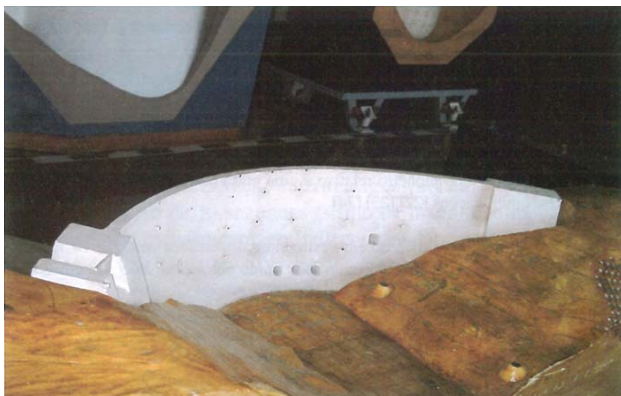
Modelo físico (LNEC) de barragem arco (EDP,EDIA)
