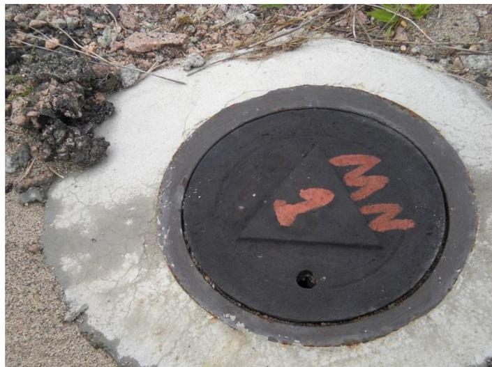
**Figura 67. Tampa de uma bateria de placas de recalques.**
