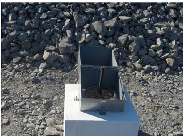
Os tubos dos piezômetros abertos podem ficar obstruídos ou danificados pelo que, tal como para os tubos inclinométricos ou para as placas de recalque, a cabeça exterior deve ser protegida por um pequeno maciço em concreto com tampa metálica, pintado e identificado tal como referido para os marcos topográficos (Figura 68).
