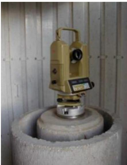
**Figura 55. Marco de referência com teodolito. (Fonte: COBA, S.A.)**
