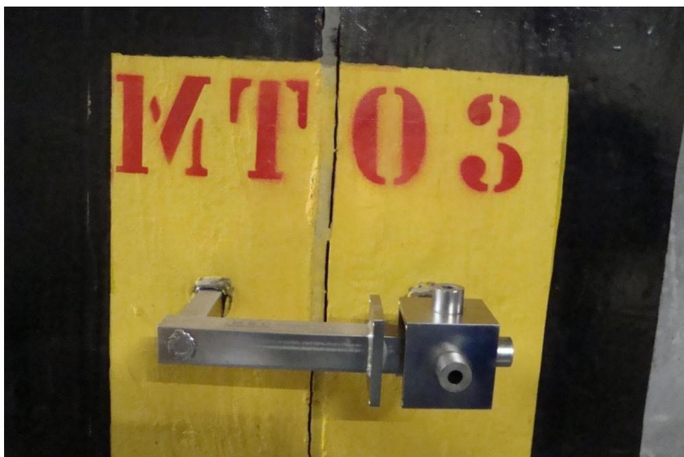
**Figura 65. Detalhe do medidor triortogonal instalado na parede da galeria de drenagem de uma barragem de concreto. (Fonte: SBB Engenharia)**
