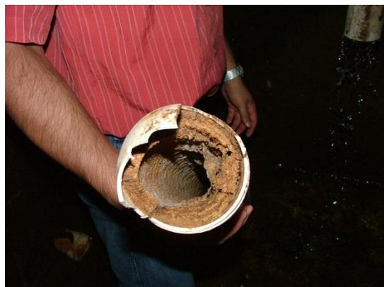
**Figura 28. Dreno de uma barragem em CCR parcialmente obstruído pela deposição de carbonato de cálcio.** (Fonte: SBB Engenharia)
