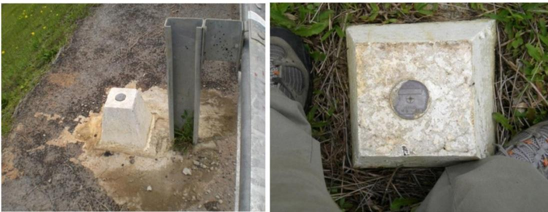
**Figura 54. Marco topográfico com peça destinada ao encaixe de bastão (menor precisão que a utilização de miras de alta precisão estacionadas nos tacos de nivelamento). (Fonte: COBA, S.A.)**
