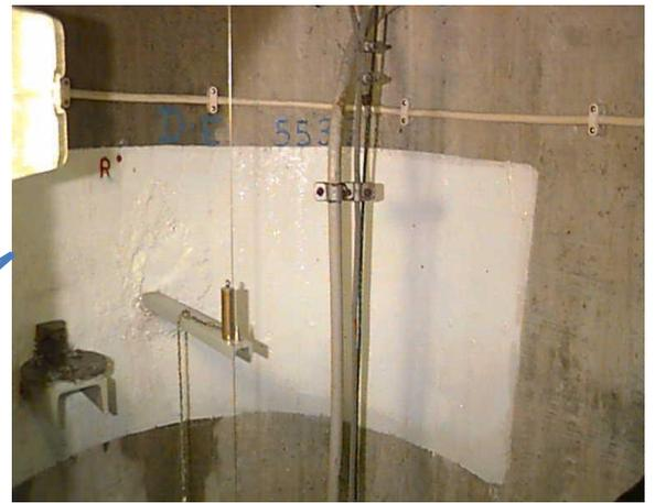
**Figura 63. Pêndulos diretos e invertidos.** (Fonte: INAG, 2001 e APA, 2013)
