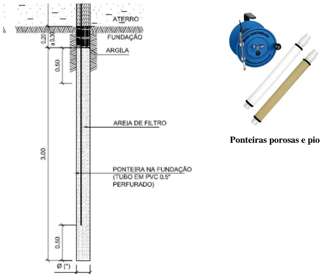
**Figura 58. Esquema de instalação de um piezômetro na fundação.**
