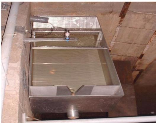
**Figura 66. Medidor de vazões com recolha automática.**
