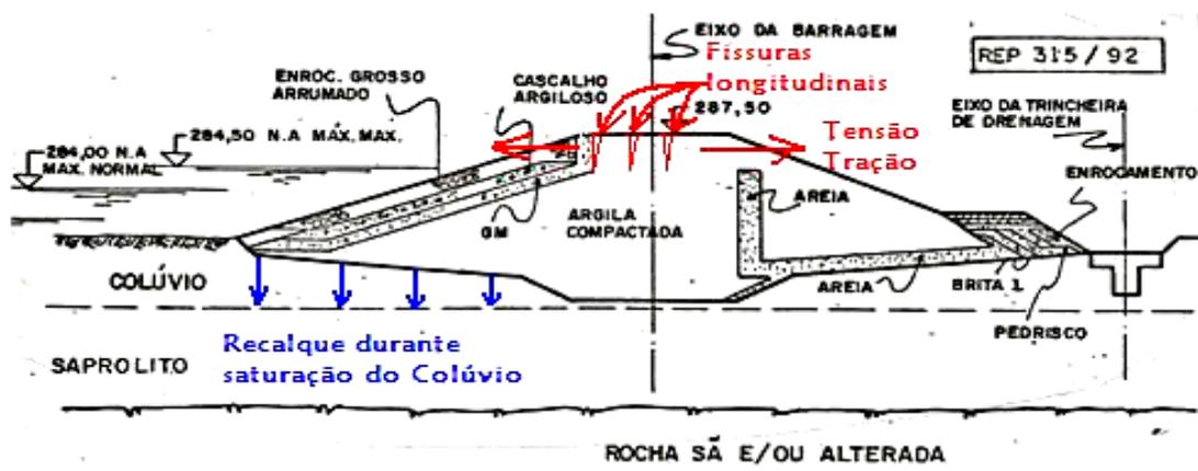
**Figura 11. Fissuras longitudinais na crista da barragem de terra no rio Paranapanema, causada pelos recalques da camada de solo coluvionar poroso na fundação.**
