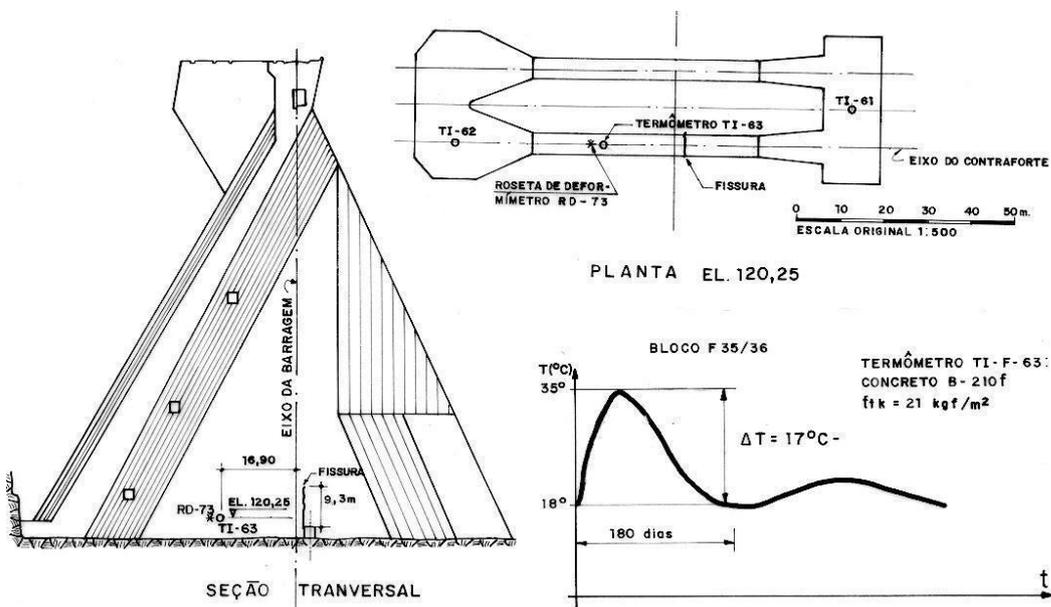
**Figura 32. Fissura vertical de origem térmica observada ao final do período construtivo em contraforte da barragem de Itaipu, provocada por uma queda de temperatura de  $17^\circ \text{ C}$ . (Fonte: SBB Engenharia)**
