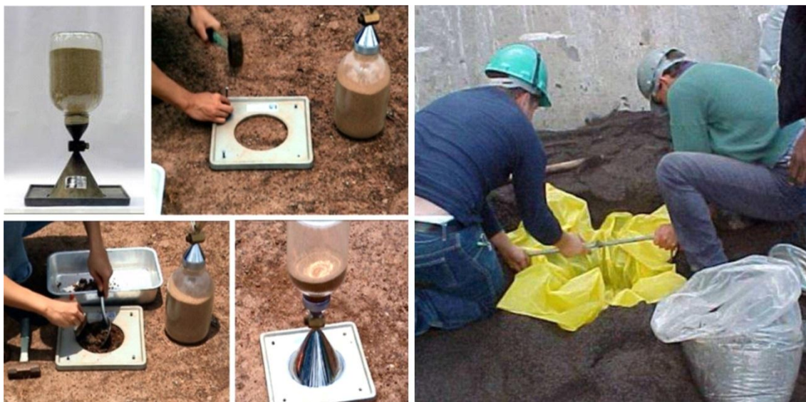
Figura 21. Determinação do peso específico do solo com frasco de areia. (Fonte: Universidade do Minho, Portugal)
