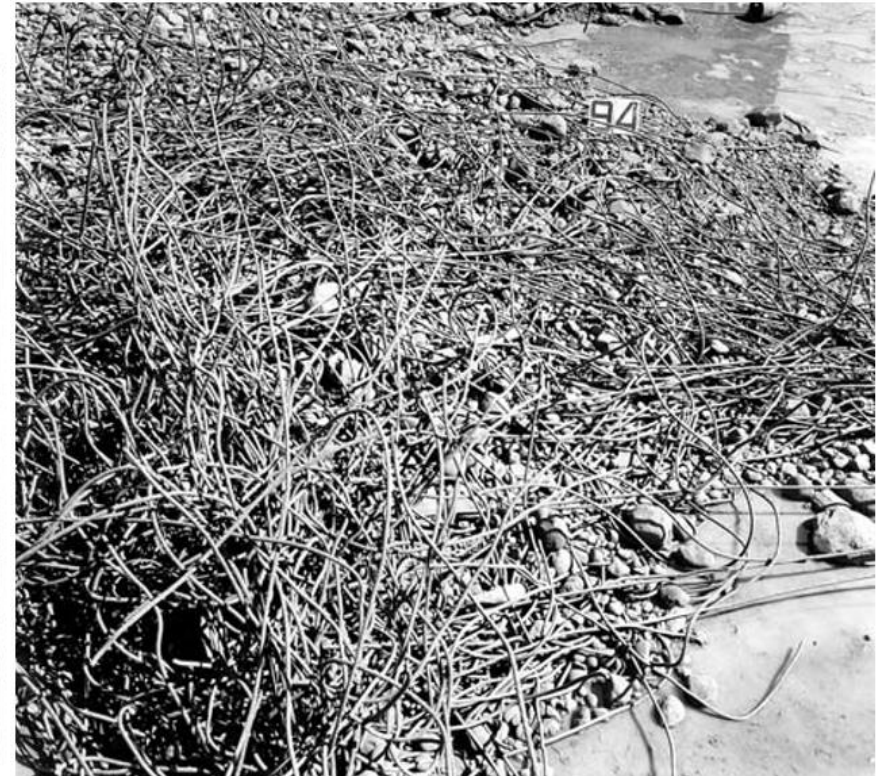
Foto 8 - Ferragens arrancadas e pedras arredondadas
